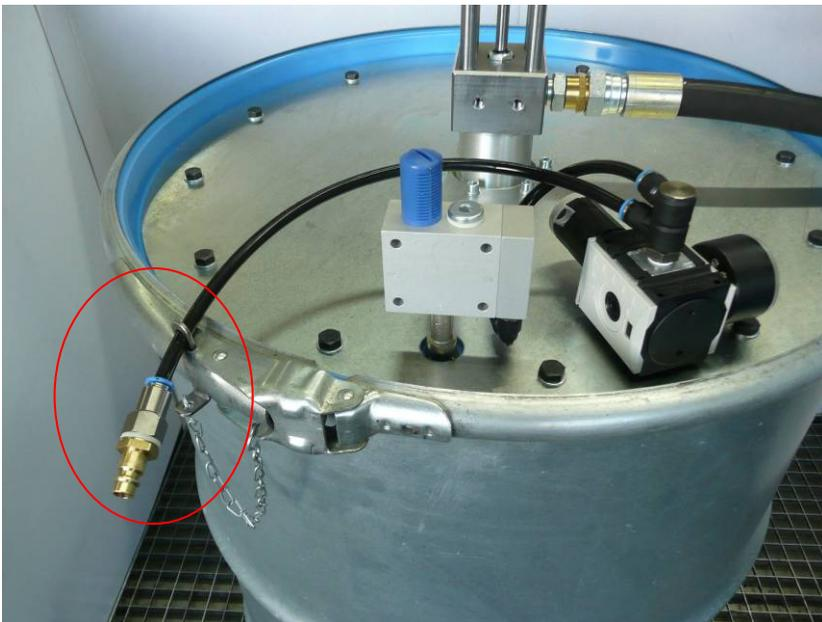
Der Deckel ist jetzt einsatzbereit. Druckluft kann angekoppelt werden.
