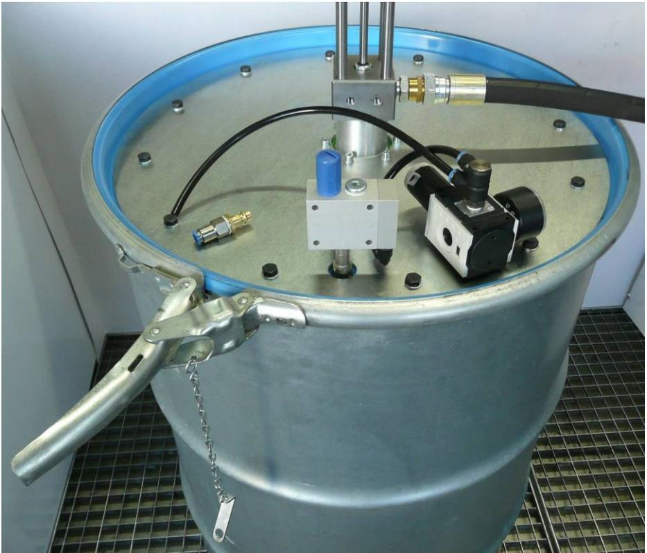
Pumpwerk mit Druckluftantrieb durch die Mittelöffnung des Deckels stecken und bis auf den Fassboden schieben.
