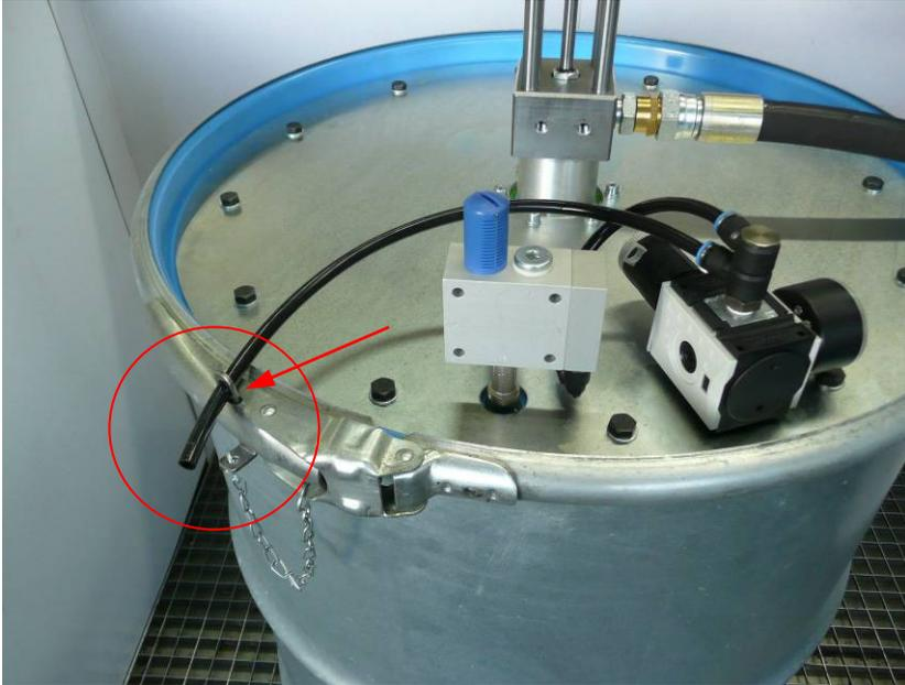
Druckluft-Anschluss auf den Luftschlauch stecken. (siehe nachfolgendes Bild)
