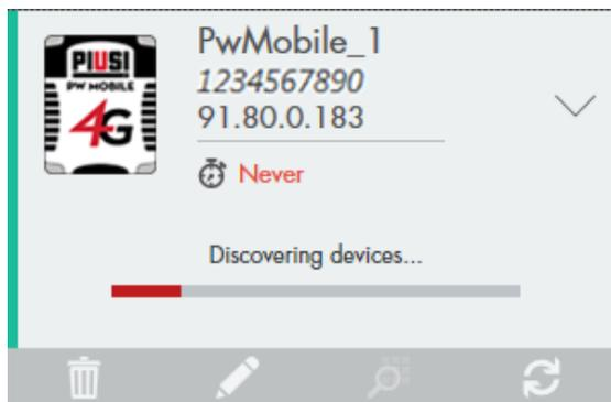
Le numéro de série du PW Mobile est validé et sera ajouté à l'installation. La procédure d'identification des périphériques connectés au numéro de série RS485 du PW Mobile s'effectuera automatiquement.
