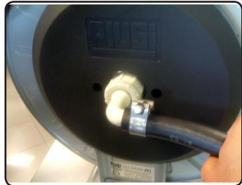
**IMPORTANT:** Utiliser un tuyau antistatique ( $R < 1m\Omega/m$ ), seulement avec huile et gasoil. Pas nécessaire pour la version eau/urée.
