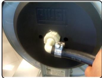
**WICHTIG:** Den Plastikschatz wieder montieren und kontrollieren, dass während der Rotation der Schlauchaufroller frei dreht.
