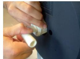
**ATENCION!** En respeto a las normas sobre la línea de alimentación del enrollador, aplicar una llave de paso a esfera, de modo de facilitar las operaciones de mantenimiento y de utilizarla como válvula de emergencia en situaciones peligrosas.
