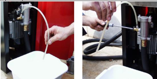
2 Introduire le petit tuyau connecté à la SOUPAPE DE DESAMORÇAGE dans un récipient et ouvrir la soupape à l'aide d'un tournevis.
