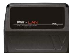
Un dispositivo che permette di convertire il segnale RS485 in LAN tramite un'interfaccia semplice e intuitiva.
