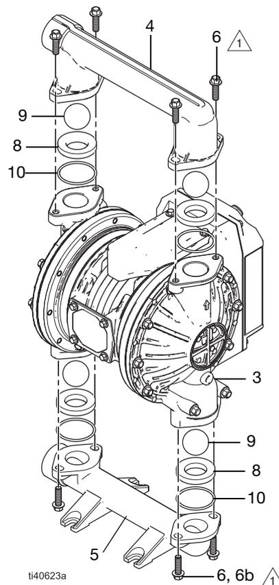
Fig. 17: Valvole di controllo
