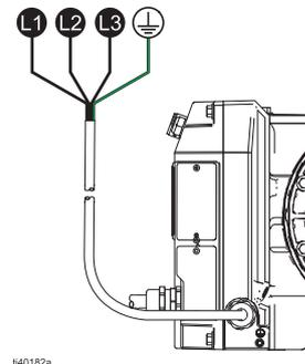
FIG. 13: Cablaggio per modelli trifase
