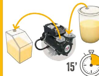
**B** Funzionamento a secco: rileva questa condizione e spegne la pompa
