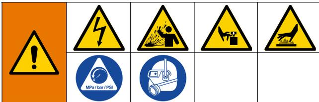
Dieses Gerät bleibt unter Druck, bis der Druck manuell entlastet wird. Um die Gefahr schwerer Verletzungen aufgrund von unter Druck stehendem Material wie z. B. Injektionen in die Haut oder Verletzungen durch Materialspritzer und bewegliche Teile zu vermeiden, nach dem Spritzen und vor Reinigung, Kontrolle oder Wartung des Systems immer die **Druckentlastung** durchführen.
