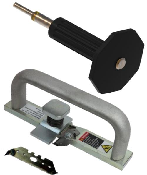
Mit dem Gurthobel 18 kann die Deckschicht eines Gurtes mit nur einem Schnitt auf 5-6 mm abgehobelt werden. Durch den einstellbaren Gurniederhalter können auch "abgenutzte" Gurte (bis max. 10 mm Gurtdicke) bearbeitet werden.
