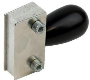
Diese Verbinder-Einsetzhilfen können zum Einsetzen von Verbinder mit Teilung 1,7 und 2,54 mm genutzt werden. Empfohlen sind diese Einsetzhilfen speziell zum Einsetzen von PATCH-Verbindern in fest installierte Käbme (geringe Platzverhältnisse). Auch Berührungen der Finger mit den Heizbacken werden somit vermieden.
