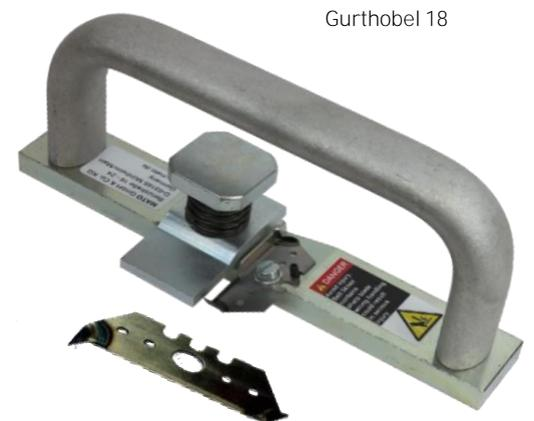
Mit dem Gurthobel 18 kann die Deckschicht eines Gurtes mit nur einem Schnitt auf 5-6 mm abgehobelt werden. Durch den einstellbaren Gurniederhalter können auch "abgenutzte" Gurte (bis max. 10 mm Gurtdicke) bearbeitet werden.
