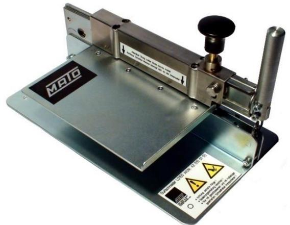
Mit dem Gurtschneider LD 150 können Gurte bis 150mm Breite rechtwinklig geschnitten werden. Bei Verschleiß des Messers, kann dieses durch die runde Form bis zu 8 mal "weitergedreht" werden (siehe unten).
