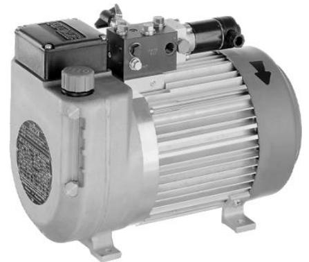
Speziell abgestimmtes Kompakt-Pumpenaggregat zur Verwendung mit der Einpresszange YM-D2S 35-68. Zweikreispumpe mit 120/140 bar in verschiedenen elektrischen Ausführungen lieferbar. Auch für den Dauereinsatz mit der Einpresszange YM-D2S 35-68 geeignet
