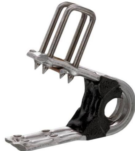
Die Ausschäumung verhindert ein Durchrieseln des Fördergutes und erhöht die Lebensdauer des Verbindestabes durch eine Fettfüllung.
