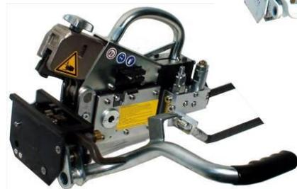
Zur Verwendung mit den Gestellen S, SS, MF und SP. Die hydraulische Einpresszange YM-D2S 35-68 installiert alle Verbinder der Serien U30, U68, S30S, E30. Der Antrieb erfolgt über Hydraulik. Druckbereich 120-160 bar / 8l/min. Inkl. Transportbehälter, siehe S.9
