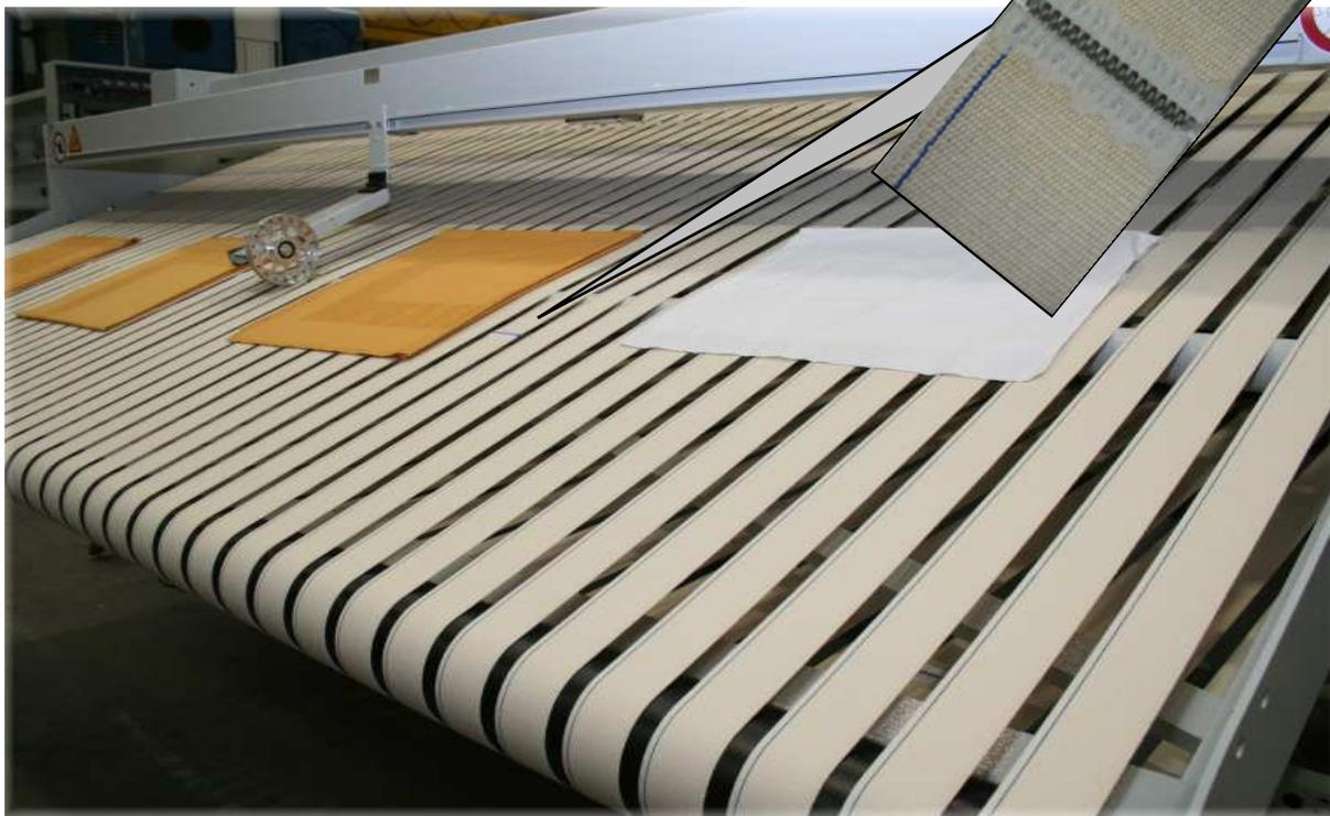
Die MATOPATCH-Verbinder sind so konstruiert, dass Verbinder und Patch in quasi einem Arbeitsgang mit den entsprechenden Einpressgeräten (vgl. Seite 13) installiert werden können. Zusätzliche Kleber und somit auch ihre Trocknungszeiten oder gar der 'Umgang mit gefährlichen Arbeitsstoffen' entfallen.
