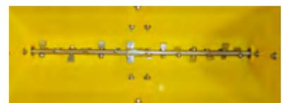
robuste Rührwelle, Achse mittig geteilt, einstellbare Rührflügel
