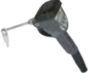
Ölabgabepistole K500,<br>mit elektronischem Zähler, Anschluss mit Drehgelenk 1/2" IG,<br>2-fach abwinkelbarer Auslass mit Antitropf-Mundstück,<br>1 - 30 l/min, max. 70 bar, mit Mengeneinstellung<br>von 0,1 - 99,9 l. Ist die voreingestellte Menge erreicht,<br>schließt die Pistole automatisch. | 8576      | 810,-      |
