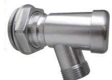
Fass Hahn vernickelt mit 3/4" AG mit PTFE-Dichtung, selbstschliessend und Feststellschraube
