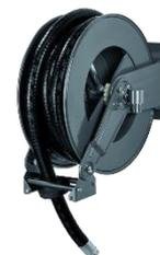
**Schlauchaufroller für Diesel DN25 offen mit Drehgelenk und Puffer, max. 20 bar**
