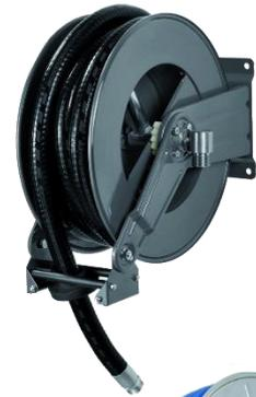
**Inox-Schlauchaufroller für AdBlue® DN19 offen mit Drehgelenk und Puffer, max. 20 bar**
